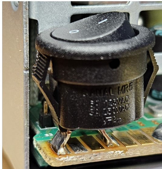
Rys. 7 Widok przylutowanego przelącznika do włączania/wyłączania zasilacza
