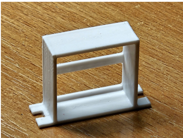
Rys. 28 Widok mocowania z drukarki 3D
