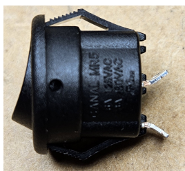
Rys. 5 Widok przełącznika z wygiętymi stykami
