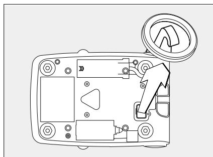
Un dispositif de pesée en dessous du socle est à votre disposition pour toutes vos pesées sous le socle de la balance.
