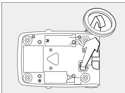
Für Wägungen unterhalb der Waage steht eine Unterflurwäggeeinrichtung zur Verfügung.
